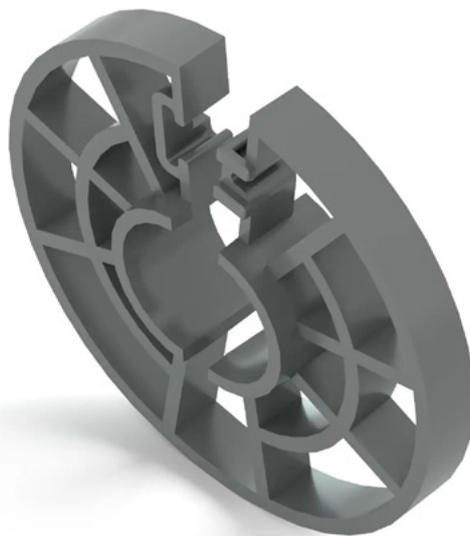
Com o sistema de “clique”, o espaçador circular clicado facilita a aplicação no caso de estruturas já armadas, contanto com o travamento manual e evitando que a peça trabalhe, não permitindo que a armação encoste na caixaria ou forma.
